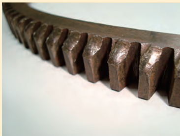
車輛側リングギヤ摩耗、損傷例
