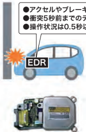
搭載が義務付けられるEDRの主な仕組み
