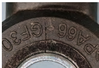
①劣化によるクラック
