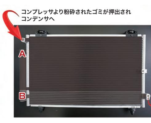
エキスパンションバルブへコンプレッサより粉碎されたゴミが押出されコンデンサへ
