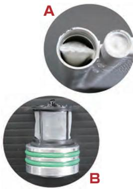
コンデンサの3/4まではフィルタの無い狭い通路を経て(すでにゴミは押し込まれています)Aのフィルターを通りBの網を経てエキスパンションバルブへ送られます。(焼付いたコンプレッサの大きなゴミはコンデンサへ行きそこを潜り抜けたゴミはレシーバへ、微粒子のゴミはオイルと共にエキスパンションバルブ・エバポレータを経てコンプレッサへ戻ります。)
