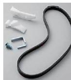
このストレッチベルトは、張力調整用のアジャスターが不要であり、固定された補機プリー間に取付け用治具を使ってベルトを伸ばしながらプリーへ装着するベルトです。
