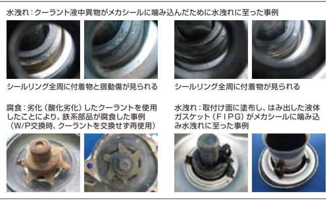
排出する為です）そして、冷却液（クーラント）が常にシール部分に入り込むので、冷却液が汚れているとシール性能の低下に直結してしまいます。
